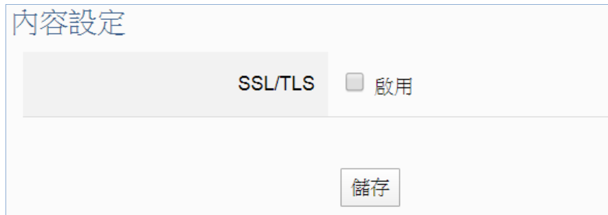
圖 125 4-4-3 憑證-SSL/TLS 預設為不啟用
