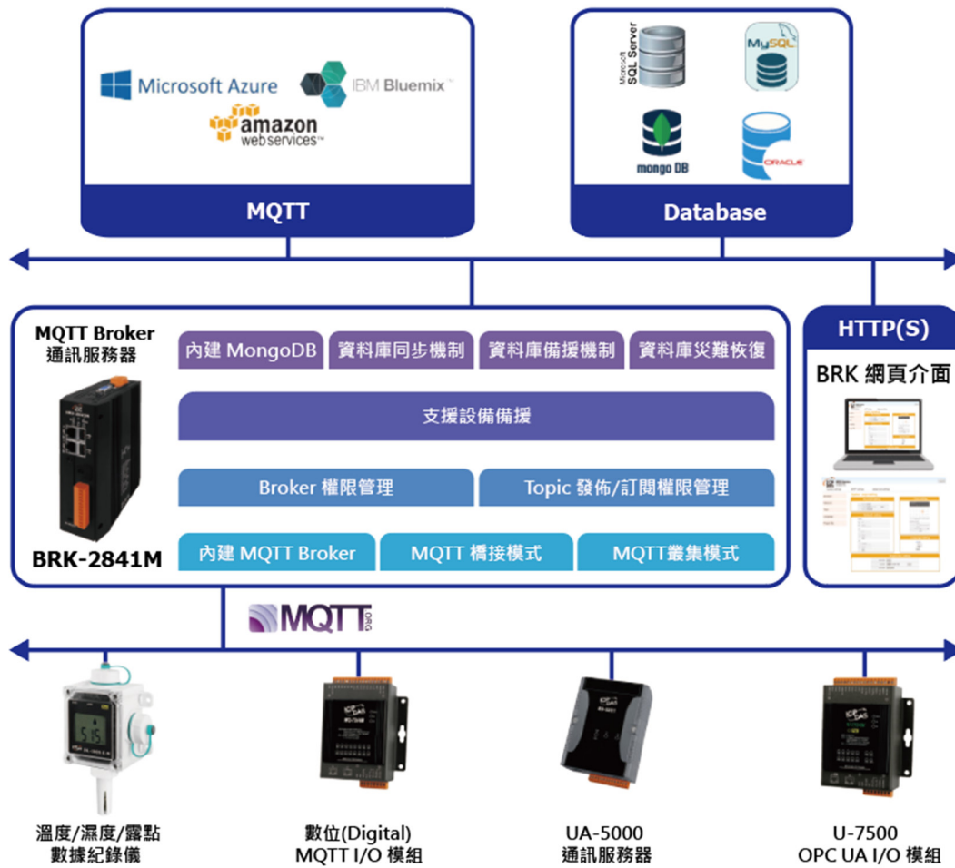
圖 3-1 BRK 的 MQTT 連線架構
