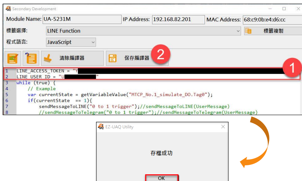
圖 5-44 二次開發-取得 UA 的 Modbus 點位，並發送訊息至 LINE (2)
