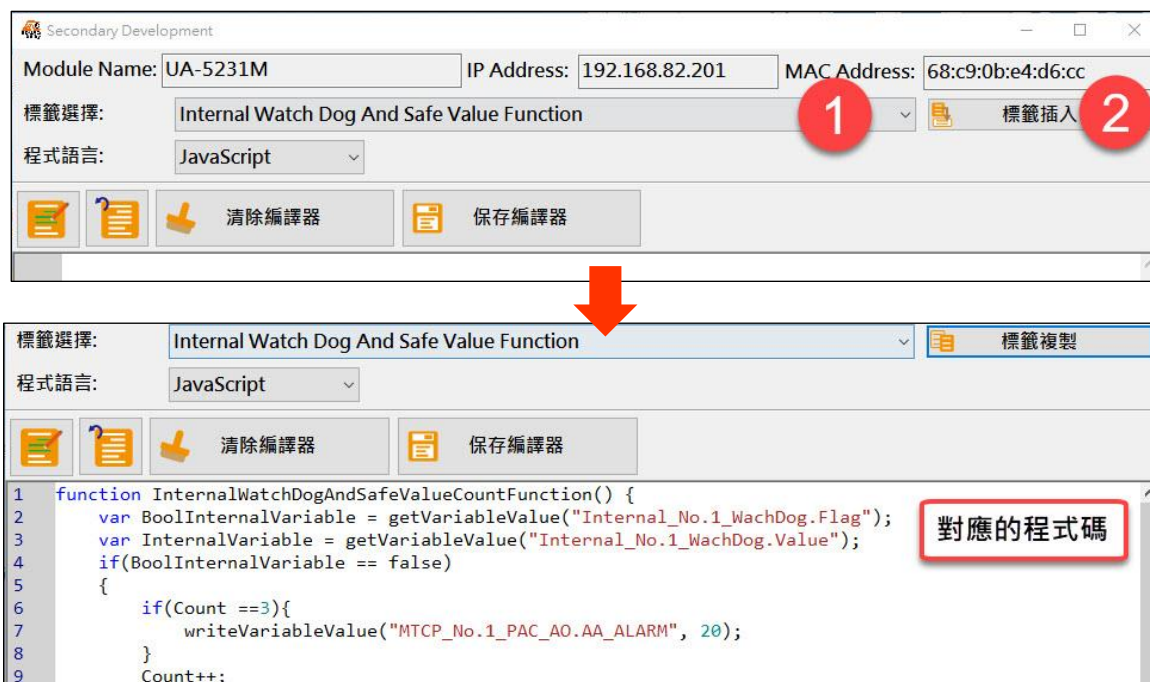
圖 5-56 二次開發-監控 SCADA 並控制 Modbus I/O (4)
