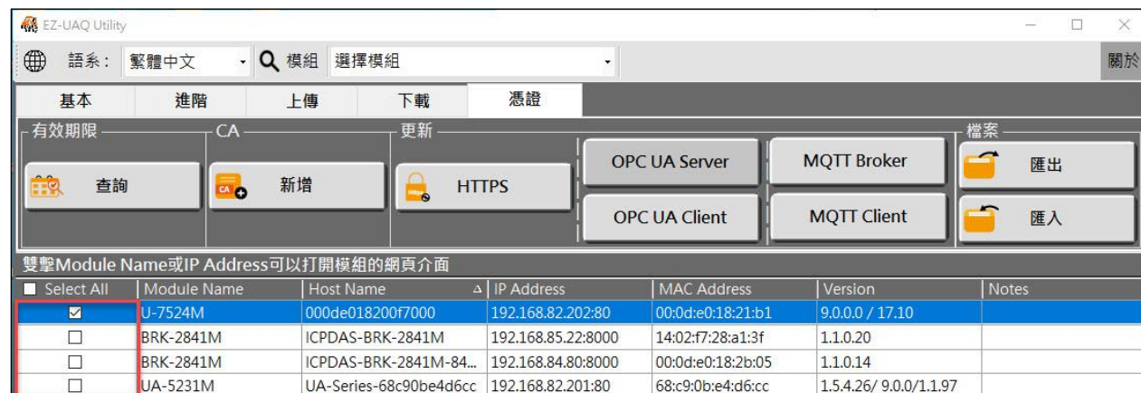
圖 5-147 UA 與 UA I/O 建立 MQTT 憑證加密通訊-更新 MQTT Client 憑證(1)
