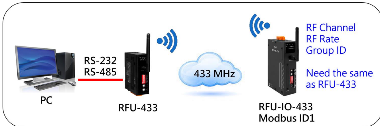
電腦透過 RFU-433 控制站號 1 的 RFU-IO-433 模組
