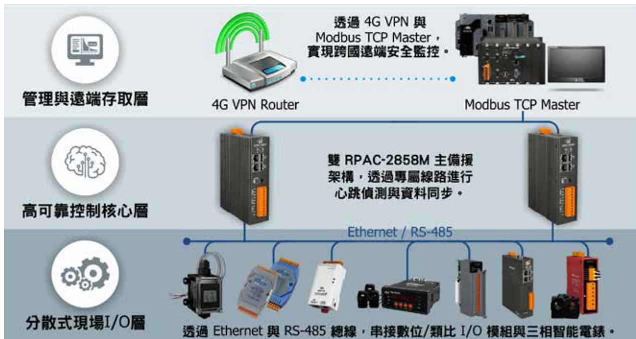
▲ 圖 1：高可靠度海岸監視系統架構圖
