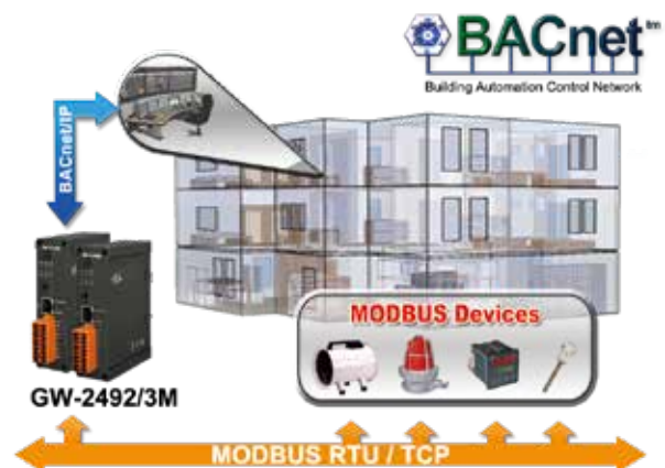
▲ 圖三 | GW-2492M / GW-2493M 可將現場 Modbus RTU / TCP 設備轉換為 BACnet/IP 通訊，協助 BEMS 平台快速整合各類建築設備與感測器。
