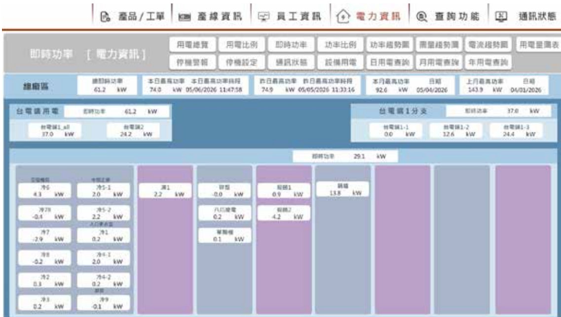
▲ 圖二 | 電力監控系統（中控），即時呈現全廠用電與設備分布，協助能源管理與異常監控。
