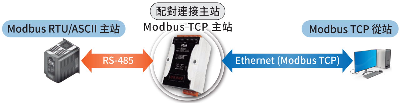
▲ 在 M7 和 M8 模式中，若 Master 為串列設備，則可以建立專屬的 TCP 連線至指定的 Modbus TCP slave 設備
