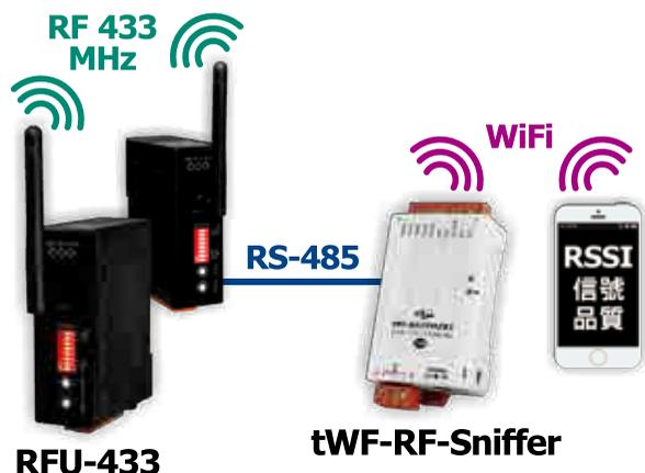
tWF-RF-Sniffer 是泓格科技研发专门帮助轻松测试 RF 通讯品质的模块, 能自动解读 RFU-433 的 RSSI 封包数值, 转换为 dBm 测量单位, 具备 Wi-Fi 连线机制以及内建网页伺服器, 使用常见的无线信号强度图标展示, 能以直观方式调试现场信号。使用者只需以手机(或任意具备 Wi-Fi 功能的设备)连线, 开启网页
