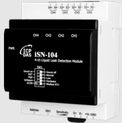
iSN-104-E 液体泄漏检测模块是一款低成本的智能液体泄漏检测设备，可直接控制触发和声音警报。无需额外的转换模块，即可以轻松与各种监控系统整合，实现远程报警和远程设备控制。iSN-104-E 模块能监测长达 500 米的双芯引出电缆，并可与延长电缆及随附的液体泄漏检测电缆一起使用。如果检测到液体，控制器会立即触发输出信号并发出警报声。该模块可方便地与连接到网络的其他数据采集主机整合。
