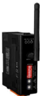
站 iWSN-200U 最大可暂存 12 笔测量信号，故 31 站 iWSN-200U 最大共可暂存  $12 \times 31 = 372$  笔测量信号。
