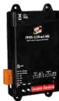
◆ 内建锂电池而无需额外布线提供电源，且第一个 4~20mA 信号测量通道在测量信号同时可从信号中取电，并对模块电池进行充电，当输入信号维持在 3mA 以上时，即可让模块的耗电与充电达到供需平衡而长期使用。
