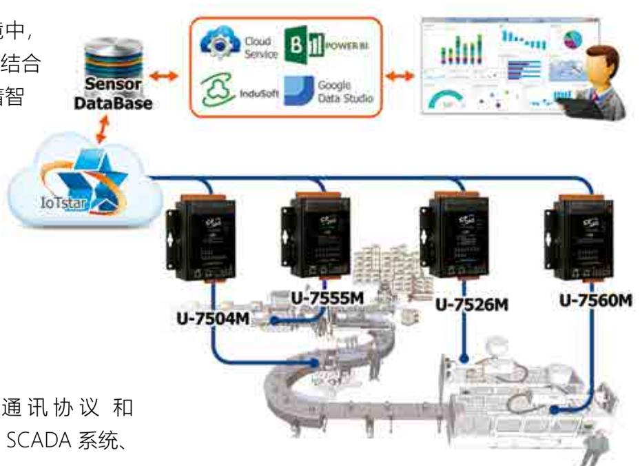
MES 系统和 ERP 系统。OPC UA 的高度灵活性和统一数据模型，结合安全机制，能够实现跨平台、跨设备、跨网络的数据交换，大幅提高工业自动化的互操作性和可靠性。不仅能够提升数据的准确性，还能确保数据传输的安全性。
