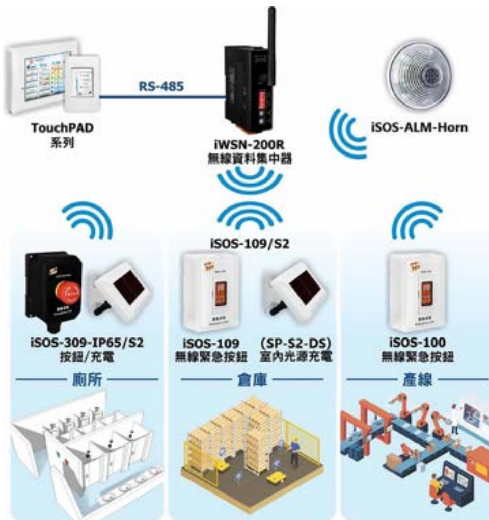
▲ 工廠生產線緊急求救監控架構
