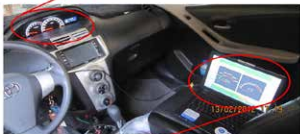
利用I-7565-H2監視車內CAN訊息，顯示引擎資訊
