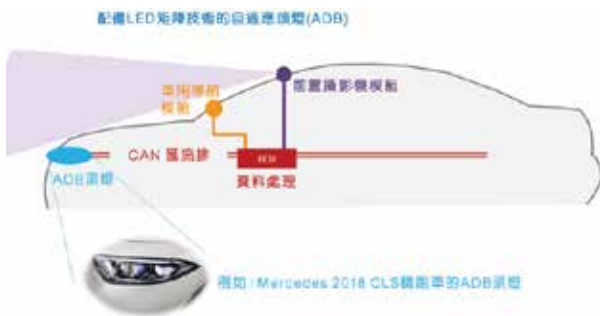
▲ 使用 ADB 技術的頭燈如何運作？(圖片來源：EE Times Taiwan)
