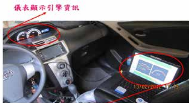
利用I-7565-H2監視車內CAN訊息，顯示引擎資訊
