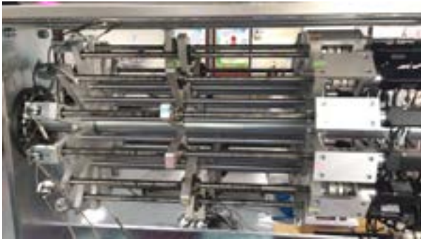
▲ 圖三、控制機箱內的多軸線性致動器
