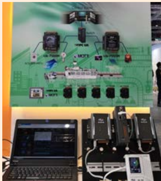
▲ UA 系列 IIoT 工業物聯網通訊伺服器，提供負載平衡及冗餘功能，讓系統更加穩定。
