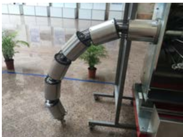
▲ 圖二、蛇臂機器人的幾個姿態
