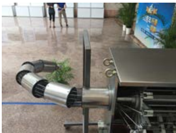
▲ 圖二、蛇臂機器人的幾個姿態
