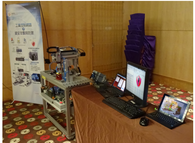
▲ 泓格科技推出 iDS-8131 工業網路資安威脅偵測分析系統，可偵測攻擊的封包並出現告警訊息
