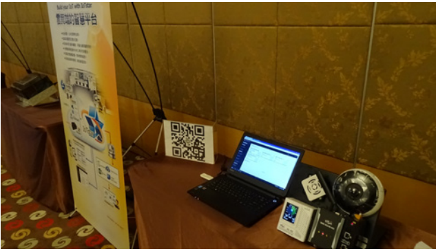
▲ WISE-5231 可將 I/O 的訊息和攝影機拍下的照片，即時推播到手機上的 Line 聯絡人和聊天室
