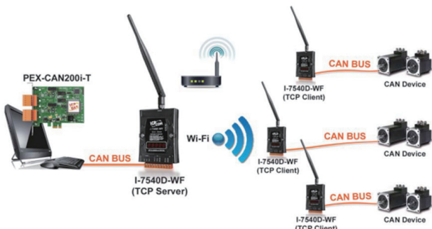
▲ 圖 4. CAN BUS 轉 Wi-Fi 之應用架構圖
