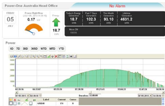
▲ 圖 2：使用 InduSoft 建立的網頁，可即時查看光電轉換器的狀態
