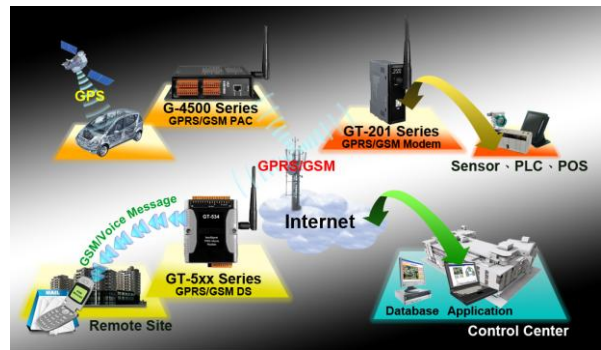
▲ GPRS / GSM 系列產品的應用架構圖。
