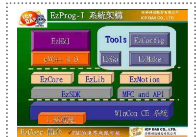
圖6 EzProg-I 系統架構圖
