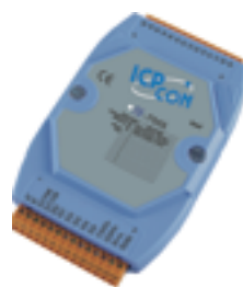
圖五 I-7005 八通道熱敏電阻輸入和六通道警報輸出模組
