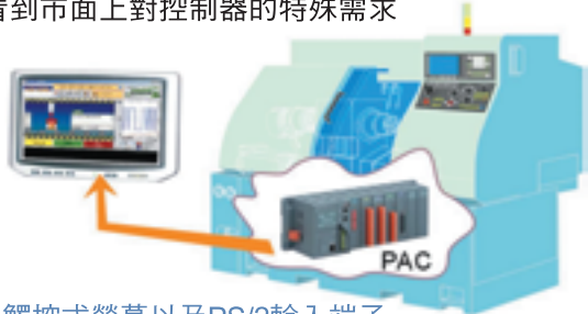
WinCon接上觸控式螢幕以及PS/2輸入端子 讓設備機台即具有HMI功能。
