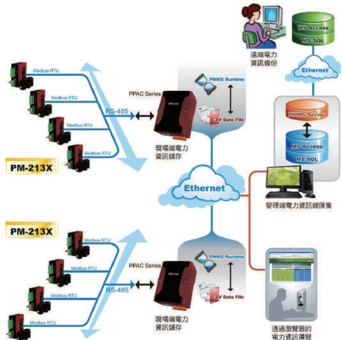
透過 PMMS 管理軟體與智能電表 有效控管廠區用電
