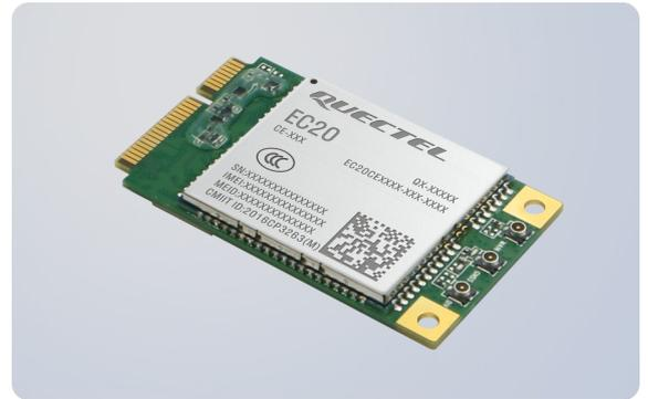
EC20-CE Mini PCIe 是一款支援 PCI Express Mini Card 標準介面的 LTE 模組。採用 LTE 3GPP Release 11 技術，支援最大下行速率 150 Mbps 和最大上行速率 50 Mbps；同時在封裝上相容移遠通信多網路制式 LTE Cat 4 EG25-G Mini PCIe 模組，實現了從 3G 網路向 4G 網路的輕鬆平滑過渡。EC20-CE Mini PCIe 模組能夠向後相容現存的 EDGE 和 GSM/GPRS 網路，以確保在缺乏 3G 和 4G 網路的偏遠地區也能正常工作。
