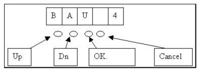
您可以利用 "UP" 或是 "Down" 鍵選擇您要的通訊速率,I-8xx7 上 x 值所代表的通訊速率如下 (0) 1200, (1) 2400, (2) 4800, (3) 9600, (4) 19200, (5) 38400, (6) 57600, (7) 115200, (8) 300, (9) 600, 及 "-"。若為 I-8437/8837,選 SEL 1 可選擇 "-" 來釋放 COM3,如此 COM3 將取消 Modbus RTU slave port 的功能,釋放後的 I-8437/8837 COM3 可以用作它途,比如 連 I-7000,或使用 Modbus Master 功能。(I-8437/8837 出貨時的 COM1 為 Modbus RTU slave port ,而 COM3 則為釋放狀態,I-8417/8817 出貨時的 COM1 及 COM2 皆為 Modbus RTU slave port)
