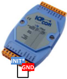
將 INIT*接腳與 GND 接腳 連接在一起
