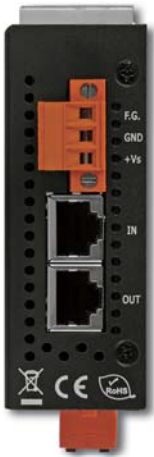
圖 2: ECAT-2091S 包含電源與 EtherCAT 介面的側視圖
