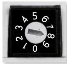
1. 網路連接完成後，將 UA 硬體斷電，再將硬體 Rotary switch 轉至 8。
