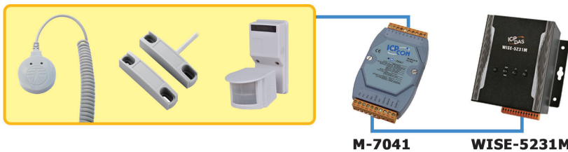
▲ 圖說：刷卡 -> DO 輸出給 M-7000-> WISE 的 if-then-else 邏輯 -> 設定系統警戒狀態或解除警戒
