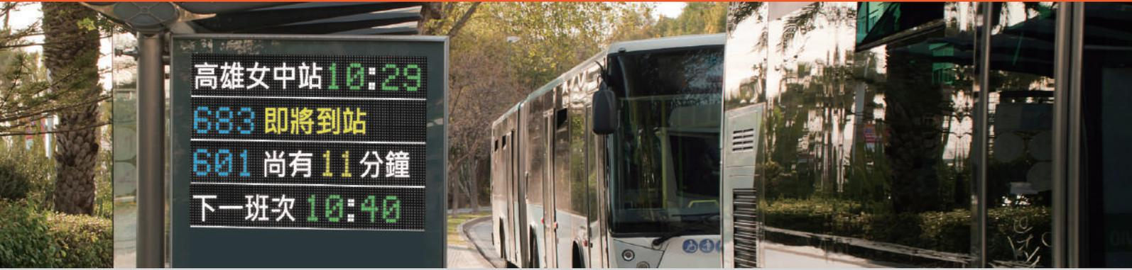
在南紡夢時代接駁車資訊顯示看板的案例上，因為園區腹地廣大，總共建有六個接駁站，單站使用了 4 支 iKAN-116S 做橫向直列組合規劃，若使用光纖進行佈線，成本太高，因此本案選擇使用 RS-485 進行串接回控制中心，並透過 Modbus RTU 通訊，將相關中文訊息及不同的字體顏色變換組合，如時間、位址、班號等資訊，顯示在各站點上。同時，iKAN 工業級 IoT 智能資訊顯示器內建的 UNICODE 與 ASCII 字元編寫功能，可針對特定參數做單獨設定，例如重要資訊顯示的字體顏色變換，提高現場訊息的辨識度。
