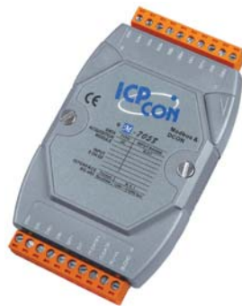
M-7058(D)/M-7059(D) 123 mm × 72 mm × 35 mm (W × L × H)
