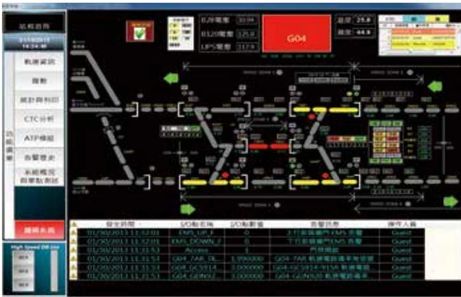
InduSoft 以圖示呈現訊號轉換器與訊號處理及控制單元，規畫即時資料畫面、累積資料畫面、圖表資料分析頁面三大類，分支的頁面包含了警報管理 ( 即時與歷史資料查詢 )、統計與分析報表、臨界值參數設定、資料庫管理、系統作業參數修改設定、軌道運作重播等操控頁面，以權限控管方式，提供管理人員與一般操作人員於車站監控室或遠端網路操作使用。
