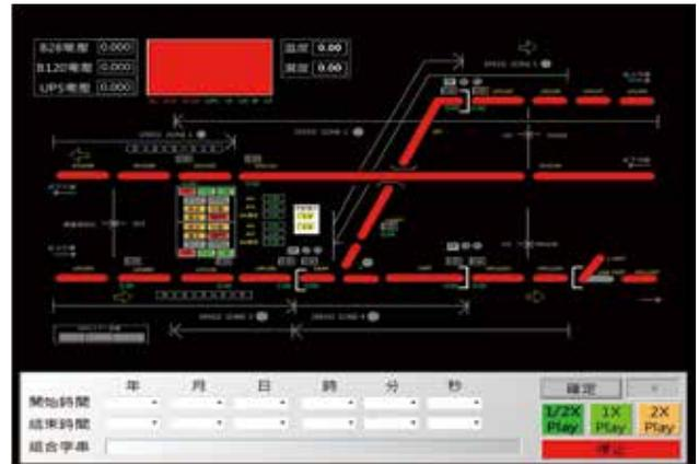
圖表資料分析頁面用於設備故障前的預警分析，下圖以道岔起始部分的轉轍器馬達舉例，轉轍器驅動馬達分正、反轉兩種模式，預警分析以馬達安裝前，設備製造商提供的馬達正 / 反轉電壓、電流、功率曲線圖為基礎樣本，比對馬達安裝後驅動轉轍器的實際量測值，依照業主提出的邊界條件（包含轉轍器正、反向啟動後到定位的時間、啟動後的量測尖峰值等），於超過邊界條件後送出警報資訊，提醒軌道保養人員做預防性的保養或是設備更換。
