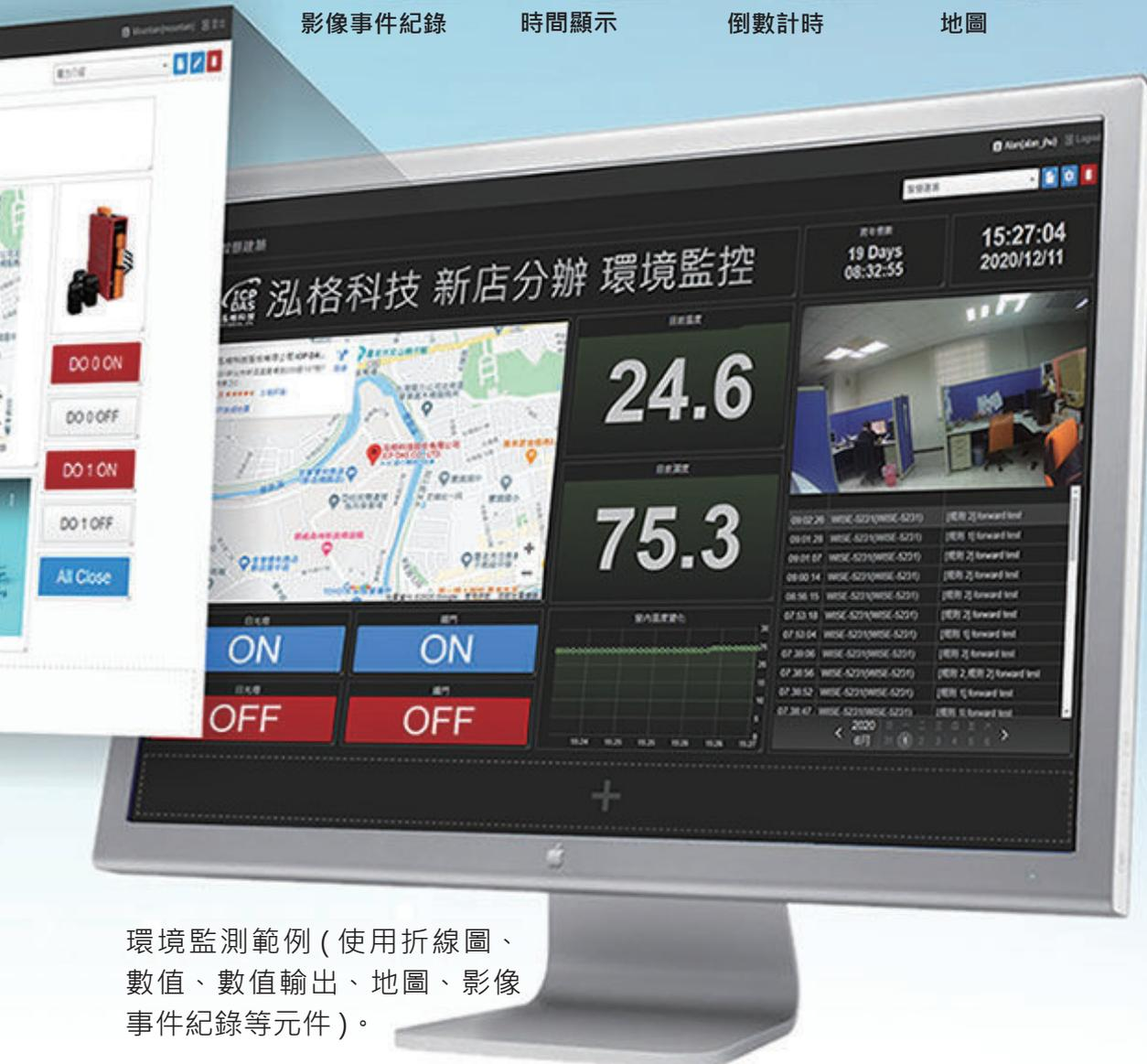
環境監測範例 (使用折線圖、數值、數值輸出、地圖、影像事件紀錄等元件)。
