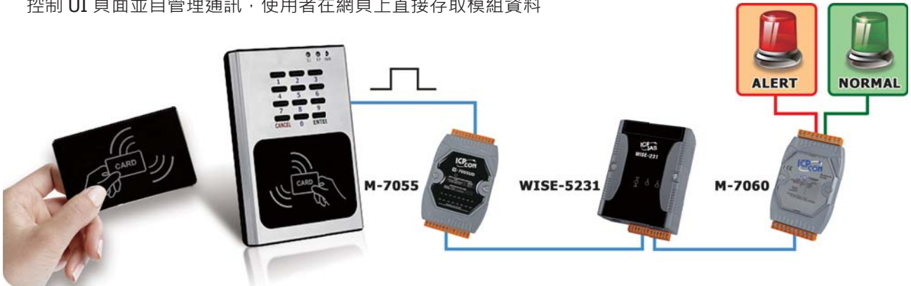
▲ 圖說：刷卡 -> DO 輸出給 M-7000-> WISE 的 if-then-else 邏輯 -> 設定系統警戒狀態或解除警戒
