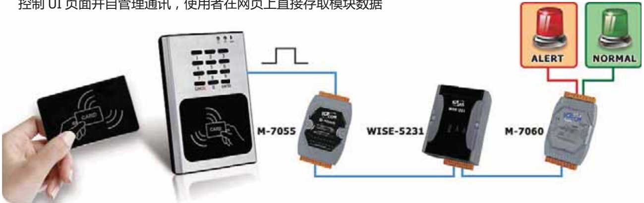
▲ 图说：刷卡 -> DO 输出给 M-7000-> WISE 的 if-then-else 逻辑 -> 设定系统警戒状态或解除警戒
