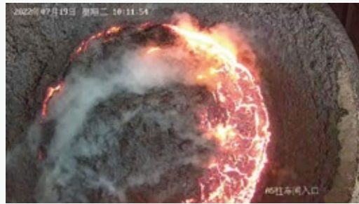
含水鋼渣倒入渣罐後產生氣爆
