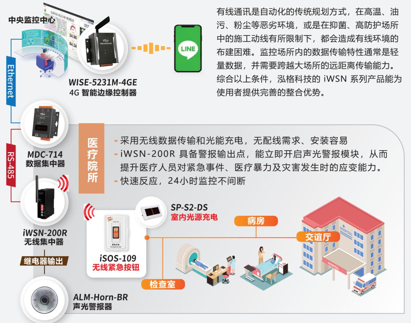
有线通讯是自动化的传统规划方式，在高温、油污、粉尘等恶劣环境，或是在抑菌、高防护场所中的施工动线有所限制下，都会造成有线环境的布建困难。监控场所内的数据传输特性通常是轻量数据，并需要跨越大场所的远距离传输能力。综合以上条件，泓格科技的 iWSN 系列产品能为使用者提供完善的整合优势。
