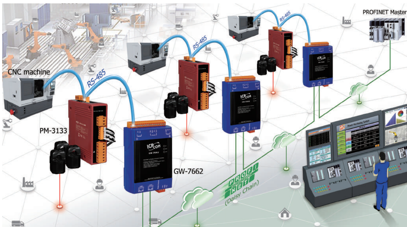
▲透過 PROFINET 的快速傳輸，可迅速取得所有設備的電力資訊
