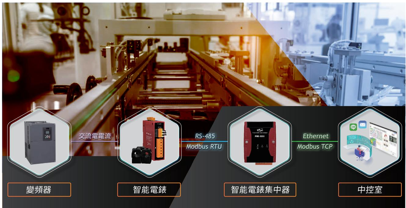
案例二：即時監控產線榨油機馬達之電壓與電流數據，進行預知保養
