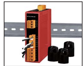
电表壁挂导轨式安装 (PM-3133 为例)
