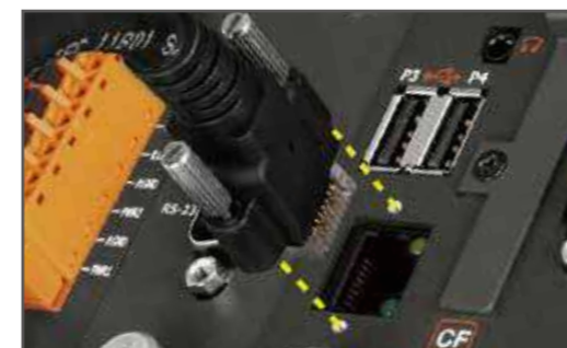
▲可螺丝锁固之 RJ45 接头
