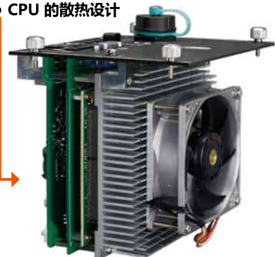
▲长寿型 CPU 散热设计
