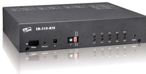
IR-310-RM 是一款專為室內設備電源控制設計之紅外線遙控 10 通道強電繼電器模組，經由序列埠通訊或紅外線遙控功能，可進行獨立或順序控制開關動作。可使用在諸如手動 / 自動電力開關、燈光情境控制與節能等應用場合。
