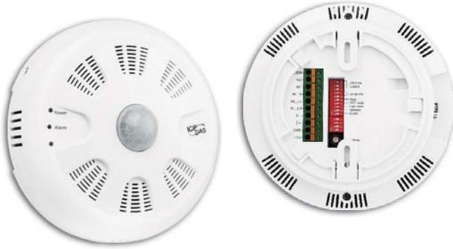
PIR 系列提供人體被動紅外線感測器、溫度或濕度感測功能。此系列適用於室內人體移動偵測，可偵測最大高度 4 米並擁有直徑 8 米的 360 度覆蓋偵測區域。支援 LUX 照度控制用來判斷白天 / 夜晚是否自動打開燈光。而溫度感測器偵測可以用於測量室溫與火災報警。支援安全警示及 EMS 保護功能，可選擇 RS-485 / ZigBee / Ethernet / Bluetooth / Wi-Fi 各通訊介面之型號，不同機種可支援 DCON, Modbus RTU/TCP 或 MQTT 通訊協定，可整合人機 / 圖控 / 中控系統，是相當適合應用於室內體感偵測的產品。
