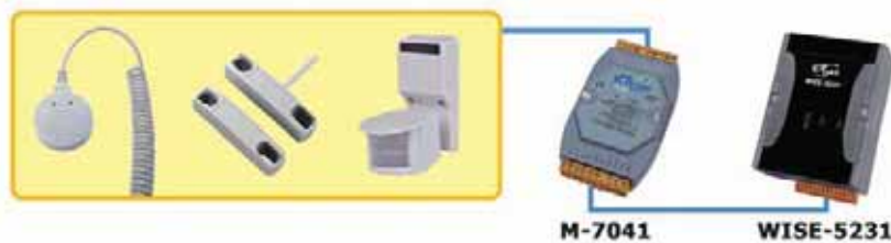
▲图说：刷卡 -> DO 输出给 M-7000-> WISE 的 if-then-else 逻辑 -> 设定系统警戒状态或解除警戒
