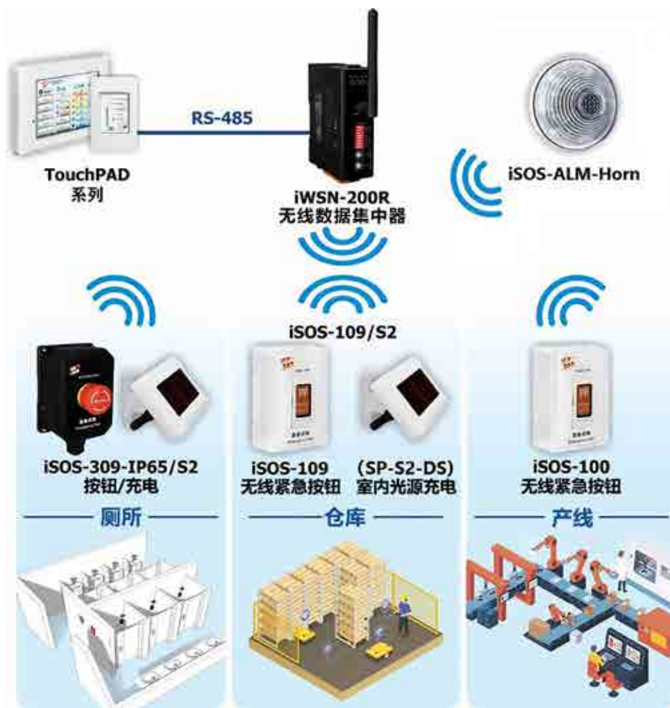
▲ 工厂生产线紧急求救监控架构
