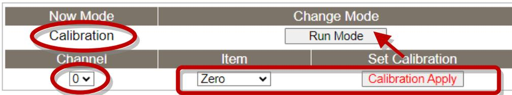
**步驟 4:** 選擇 **Zero** 校正，透過數位電錶輸入電壓 (或電流) 並使用三用電表確認輸入值，再點選 **Calibration Apply** 按鈕，來執行校正。
