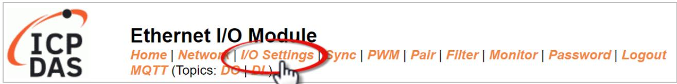
I/O Settings 頁面，依據 I/O 類型提供了 **Analog Input Configuration, Calibration, DI/DO Configuration** 與 **DO Control** 設定區塊...等等，能讓用戶配置 I/O 或校正參數，詳細的功能說明如下。
