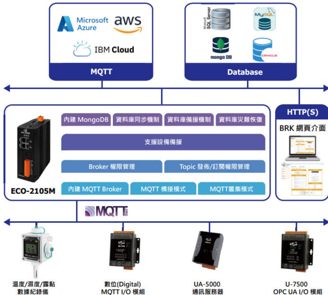
圖 3-1 ECO 的 MQTT 連線架構
