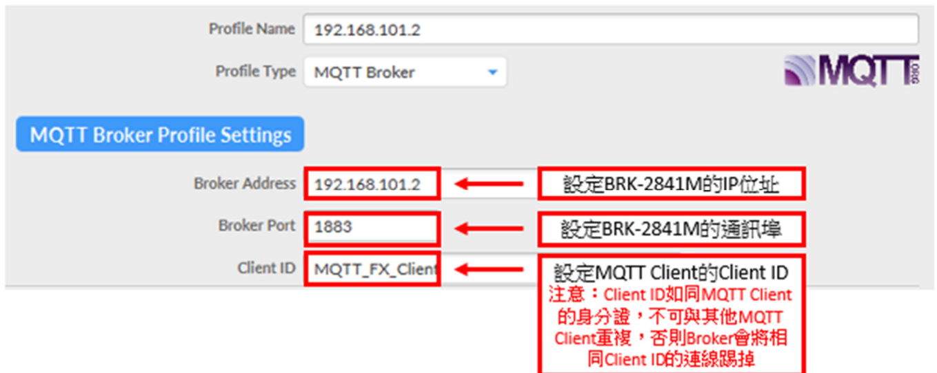
圖 3-2 使用 ECO-2000 (Broker) 將 MQTT 訊息進行轉發(1)
