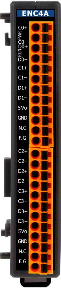
圖 4: EC4-ENC4A 包含編碼器輸入介面的側視圖
