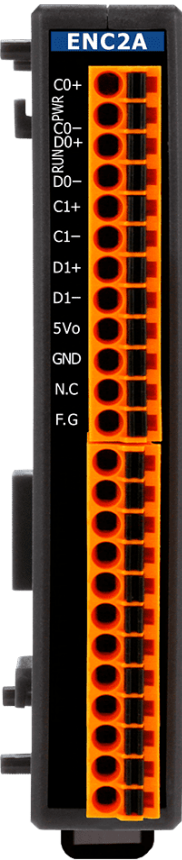
圖 4: EC4-ENC2A 包含編碼器輸入介面的側視圖
