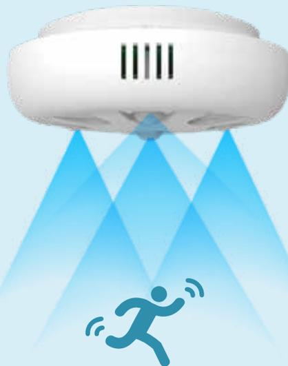
靈敏型 PIR-234/PIR-234L 模組，內建 4 個 PIR 紅外線感測模組設計，大幅提高人員感測靈敏度，可偵測最小至 3 公分幅度動作，適合應用於人員動作幅度較小的場域，避免未感應到存在人員而導致燈光熄滅的情況。穩定的照明控制，讓您可專注於會議、工作、閱讀以及各種室內活動。
