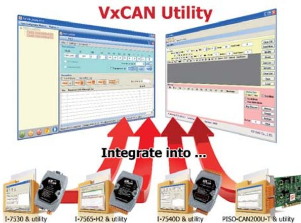
為了滿足各種應用，VxCAN Utility 不僅只有發送與接收 CAN 訊息功能，還具備訊息觸發、群傳輸、數據紀錄。用戶可以在 VxCAN Utility 中設置一些觸發條件。如果達到這些條件，它將發特定的訊息，例如停止接收訊息、啟動數據日誌的訊息。群傳輸功能允許用戶安排一組訊息。讓用戶可以先安排需要依序發送的 CAN 訊息，再通過手動觸發發送組或一些特定的規則發送。當用戶想要控制或配置設備進行測試時，此功能很有用。啟用訊息記錄功能後，可以將 VxCAN Utility 的接收訊息保存在文件中。這可以幫助用戶清楚地了解系統網絡中發生的情況，從而更有效、更輕鬆地解決系統問題。
