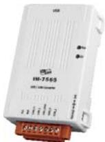
tM-7565 是一個微小化 USB 轉 CAN 的轉換器，它的體積小所以它可以應用在狹小的環境中。由於它帶有 USB 介面，因此更容易透過筆電來使用。它的電源端與 CAN 總線端帶有隔離保護且它擁有良好的效能。tM-7565 的功能完全相容於 I-7565。此外，它提供新的功能：監聽模式。使用者可以使用此功能來監聽 CAN 總線訊息並進行錯誤偵測。根據以上特性，tM-7565 是一個經濟又實惠的 USB 轉 CAN 轉換器的解決方案。
