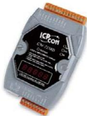
GW-7238D 和 GW-7228 一樣是 J1939 與 Modbus 主站閘道器，差別在 GW-7238D 具備乙太網連接埠作為 Modbus TCP 伺服器，可以同時與多達 5 個 Modbus TCP 客戶端連結。GW-7238D 也提供 RS-232 和 RS-485 連接埠作為 Modbus RTU 從站設備，並和 Modbus RTU 主機端與 J1939 網路中的設備進行數據交換。Modbus TCP 伺服器及 GW-7238D 的 Modbus RTU 從站功能可以同時運行，代表使用者可以更加靈活地將 GW-7238D 應用在應用程式中。對於 J1939 CAN 網路，GW-7238 支援 PDU1、PDU2、廣播與特定 J1939 訊息，可以廣泛的應用在 J1939 相關應用之中。
