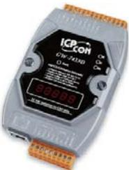
GW-7433D 是一種經濟型現場總線解決方案，為 Modbus 設備和 CANopen 設備之間提供通訊轉換機制。GW-7433D 會定期彙整來自 CANopen 從站的訊息，並在接收 Modbus 命令時將資料回傳到 Modbus TCP 從端或 Modbus RTU 主端。當 Modbus TCP 從端或 Modbus RTU 主端需要輸出資料至 CANopen 從站設備，GW-7433D 會將接收到的 Modbus 命令轉換為 CANopen 訊息再傳送到 CANopen 從站。Modbus TCP 伺服器與 Modbus RTU 從站的功能可以同時在 GW-7433D 運作，GW-7433D 也提供 Modbus 暫存器記錄 CANopen 從站的工作狀態，諸多功能讓使用者可以確實、靈活的設置應用程式。
