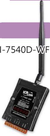
I-7540D-WF 支援根據 802.11b/g 網路標準的無線傳輸，能夠在 CAN 及 WLAN 網路之間輸送 CAN 數據。I-7540D-WF 提供作為 CAN 與 WLAN 轉換器，以及 CAN 網路無線透明化傳輸的功能，非常適合在通訊範圍約 100 公尺以內連結可移動（車輛或機器）或固定的 CAN 網路。藉由使用適當配置的路由器，可以判斷 CAN 數據從 CAN 網路傳送或過濾到乙太網。藉由使用兩個 I-7540D-WF，不僅能以無線網路連結設備取代實體接線，並能夠連接某些難以連結的 CAN 設備，例如旋轉機械。
