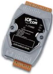
I-7540D 是 CAN 與乙太網轉換器，通常用來作為乙太網與 CAN/RS-232/485 設備的伺服器。I-7540D 支援介面存取功能與虛擬 COM 連接埠技術，幫助使用者藉由虛擬 COM 連接埠取得 CAN、RS-232、RS-485 的資料。I-7540D 也提供透明化模式，讓 CAN 總線能和網際網路或乙太網整合，從而實現遠端監控與控制。藉由微型作業系統、協定獨立性、小型外殼與靈活性等特點，I-7540D 能夠適用在廣泛的 RS-232、RS-485 及 CAN 應用之中，它可以是專門的 RS-232、CAN、Modbus、CANopen、DeviceNet 或 J1939 協定。
