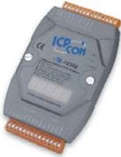
I-7232D 是 CANopen 從站與 Modbus RTU 主站閘道器，讓 CANopen 主機端能夠訪問 Modbus 從站設備。在 CANopen 網路中，I-7232D 可以是 NMT 從站、SDO 伺服器、PDO 生產者或消費者。而從 Modbus 網路的角度來看，I-7232D 是 Modbus RTU 主站，它輪詢全部的 Modbus RTU 從站預設數據，並同時將 CANopen 主端的控制命令轉傳到各個 Modbus 從站。I-7232D 符合 CANopen 的 CiA-301 v4.02 與 CiA-401 v2.1 規範，提供 CANopen 協定的許多功能，例如動態 PDO、EMCY 物件、故障時的安全值輸出、同步循環與非同步循環。和 I-7231D 一樣，EDS 文件由實用工具軟體提供，使用者可以使用 EDS 文件輕鬆的將 I-7232D 與標準的 CANopen 主站進行應用。
