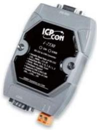
I-7530 被設計用於將傳統的 RS-232 設備整合到 CAN 總線，是一個 RS-232 與 CAN 轉換器，能透過 RS-232 通訊介面實現所有 CAN 總線的功能，並且能在 CAN 總線及 RS-232 設備之間進行訊息轉換。I-7530 的 CAN 介面遵循 ISO 11898-2 規範，支援速率最高可達 1 Mbps。當使用者需要同時控制多個 RS-232 設備時，I-7530 能夠提供與其連接的 RS-232 設備 ID，這些設備在 CAN 總線中組合，並透過設定配對連線模式由 CAN 主站設備進行控制。
