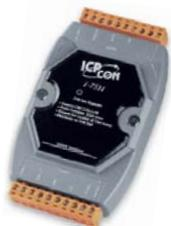
I-7531 是一種隔離型的 CAN 中繼器，用於建立 CAN 總線系統中兩個區段的物理耦合。I-7531 被設計用於隔離 I-7531 的兩個 CAN 連接埠之間的雜訊及干擾，當因為總線電纜粗糙或雜訊導致 CAN 訊號衰弱時，I-7531 能夠將 CAN 訊號復原成原先的型態。此外，I-7531 也能實現和分支線路一樣的樹狀網路拓樸。為了方便使用者利用 I-7531，模組具備自動速率偵測功能以匹配 CAN 網路，使用者只須將 I-7531 連結到 CAN 總線、確認終端電阻後進行通電，隨即便能正常使用 I-7531。
