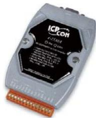
I-7530A 是 RS-232/422/485 與 CAN 的轉換器，它是 I-7530 系列的产品，具備 I-7530 的所有功能。I-7530A 的 CAN 介面遵循 ISO 11898-2 規範，支援速率最高可達 1 Mbps，並含一個 COM 連接埠。當 I-7530A 運行時，只能從這些 COM 介面之一（例如 RS-232、RS-485 或 RS-422）接收命令，而接收到的 CAN 訊息會被轉發到所有的 COM 介面。
