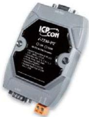
I-7530-FT 是一種低速但可靠的 CAN 與 RS-232 轉換器，"FT" 表示具備 "容錯" 的功能。I-7530-FT 符合 ISO 11898-3 通訊標準，適合用於在帶有雜訊的惡劣環境中運行的應用。一般來說，I-7530-FT 是透過雙線的 CAN 總線和其他的 CAN 設備進行通訊，如此假使其中一條 CAN 總線發生故障，也能使用另一條線路拜訪 CAN 設備。I-7530-FT 的免費的工具軟體支援發送或接收 CAN 訊息，以及 I-7530-FT 的設置功能，幫助您診斷 CAN 總線。
