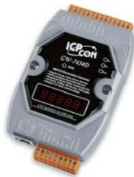
GW-7434D 是經濟型的解決方案，提供 DeviceNet 及 Modbus TCP 通訊協定的轉換功能，可以有效解決將 DeviceNet 連結到乙太網 PLC、HMI 或 SCADA 所組成的控制或監控系統的問題。與 GW-7243D 不同的是，GW-7434D 作為 DeviceNet 主站設備除了 "Group 2 Only Server" 功能以外，還支援預設主 / 從連接集 ( Predefined Master/Slave Connection Set )，並且能夠自動循環拜訪 DeviceNet 從站設備。如果 PLC、HMI 或 SCADA 要使用 GW-7434D 訪問 DeviceNet 從站設備，還要同時藉由 RS-232 或 RS-485 連接埠與 Modbus 從站或 COM 設備連結，GW-7434D 就會作為 Modbus TCP 或 VxComm 伺服器，交換這些設備的資訊。
