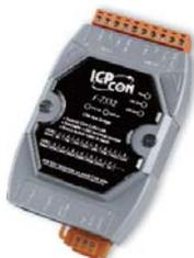
I-7532 是 CAN 總線橋接器，可以整合兩個使用不同速率的 CAN 網路。相較於 I-7531，I-7532 具備三個主要的特色功能：第一，I-7532 兩側的 CAN 總線傳輸距離限制是獨立的，意味著使用者可以將 CAN 網路的總距離延伸得更加長遠。第二，當其中一個 CAN 連接埠發生錯誤（例如位元錯誤），其他的連接埠不會因為受到影響而無法照常作業。第三，兩個 CAN 連接埠的速率與 CAN 訊息過濾器設定可以根據使用者的應用進行調整。這些功能特色能夠有效幫助使用者，得以更加靈活、有效率的設計應用程式。
