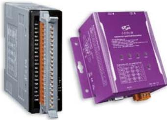
I-2534/I-5534-M 提供 4 個獨立且帶有隔離的 CAN 連接埠，可以連結 4 個 CAN 網路。I-2534/I-5534-M 符合 ISO 11898-2 通訊規範，適用於大多數以 CAN 為基礎的協定。為了適應工業應用的環境，I-2534/I-5534-M 提供重組 CAN 訊號與隔離 4 個連接埠之間干擾的功能。當使用者在連結多種不同鮑率設備的 CAN 網路中使用 I-2534/I-5534-M，I-2534/I-5534-M 會提供鮑率設定、CAN 訊息過濾器與訊息路由器等功能，可以有效解決關於網路間的數據交換、訊息過濾及路由，以及 CAN 總線樹狀拓樸的問題。此外，I-2534/I-5534-M 每個 CAN 連接埠的傳輸距離限制是獨立的，意味著使用者可以將 CAN 網路的總距離延伸得更加長遠。
