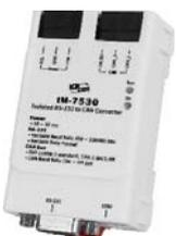
tM-7530 是一個精簡型，兼具成本效益及低功耗的模組。tM-7530 可以將傳統的 RS-232 設備整合進 CAN 總線，是 RS-232 與 CAN 的轉換器，能透過 RS-232 通訊介面實現所有 CAN 總線的功能，並且能在 CAN 總線及 RS-232 設備之間進行訊息轉換。tM-7530 的 CAN 介面遵循 ISO 11898-2 規範，支援速率最高可達 1000 bps，而 RS-232 則支援高達 230400 bps。tM-7530 的功能大致上與 I-7530 系列相同，例如同樣具備基本通訊以及配對連線模式等。
