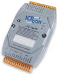
I-7242D 允許位於 DeviceNet 的主端和在 Modbus RTU 中的從站設備進行通訊，屬於 DeviceNet "Group 2 Only Slave" 設備，並支援預設主 / 從連接集 (Predefined Master/Slave Connection Set) 功能。從 Modbus 的角度來看，I-7242D 是一個 Modbus RTU 主站模組，它會輪詢 Modbus RTU 從站設備所有的預定數據，並將 DeviceNet 控制指令轉傳到 Modbus 從站設備。也因此，I-7242D 被廣泛的應用在樓宇自動化、遠端資料蒐集、環境控制與監控、實驗室設備研究工廠自動化等領域。I-7242D 也提供實用工具軟體，幫助使用者設置 I-7242D 的參數並建立 EDS 文件檔案，藉由 I-7241D 的 EDS 文件，有助於在 DeviceNet 的應用程式中使用 Modbus RTU 設備。
