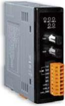
I-2533 是一款智能型 CAN 橋接器，可以使用光纖建立兩個 CAN 總線系統之間的連結。類同 I-2532，I-2533 也能在各種以 CAN 協定為基礎的環境進行應用，可將 CAN 總線訊號轉換為光訊號，並重整 CAN 電氣訊號。I-2532 和 I-2533 的差別，在於 CAN 的配置功能與通訊距離限制。I-2533 提供可設定 CAN 鮑率及 CAN 訊息過濾器的功能，這在使用 I-2533 連結具有相異鮑率的兩個 CAN 網路時有很大的幫助。藉由使用 I-2533，CAN 總線系統因為鮑率的關係，傳輸距離限制不會降低。這也意味著可以更加擴展總體的網路長度，讓使用者能夠開發出更強大、靈活的應用。
