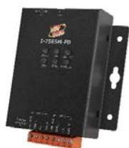
I-7565M-FD 是具有兩個 CAN 通道的 USB 轉 CAN/CAN FD (CAN with Flexible Data-Rate) 總線轉換器，它符合 CAN 2.0A/2.0B 及 CAN FD 協定標準，並且提供使用者自定義的 CAN 總線通訊速率 (仲裁欄位：10Kbps 到 1Mbps，CAN FD 資料欄位：100Kbps 到 10Mbps)。如果使用者需在 PC 或筆記型電腦上使用此模組時，在正確的使用 USB 介面連接電腦與 I-7565M-FD 後，電腦會自動載入相關的驅動程式。也因此，透過應用 I-7565M-FD，使用者可以更容易、更快速地進行 CAN 總線網路的數據收集和處理，合適的應用領域可以是 CAN 總線監控、樓宇自動化、遠端數據採集、環境控制與監控、實驗室設備與研究、工廠自動化等。
