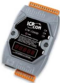
GW-7243D 具備 DeviceNet 從站與 Modbus 主端的功能，能夠讓 DeviceNet 主端訪問 Modbus 從站設備。GW-7243D 在 DeviceNet 中是作為 "Group 2 Only Server" 設備，為與 DeviceNet 機端進行連結待命；在 Modbus 則作為主端使用，可以循環發送命令以拜訪 Modbus 從站設備。GW-7243D 的 Modbus TCP 客戶端與 Modbus RTU/ASCII 主站介面可以同時運作，這項功能表示不論通訊設備使用乙太網、RS-232 或 RS-485 通訊介面，使用者都能將不同類型的 Modbus 從站設備整合到 DeviceNet 網路中。為了簡化 GW-7243D 的使用，GW-7243D 實用工具軟體可以進行模組設置及建立 EDS 文件檔案，讓使用者能更加輕鬆的建構應用程式。
