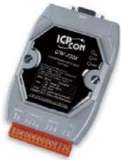
GW-7228 使 Modbus RTU 主端能夠與 J1939 網路中的設備交換數據，並藉由 RS-232、RS-422 與 RS-485 連接埠提供 Modbus 從站功能，讓 Modbus RTU 主端可以輕鬆的控制與監看 J1939 設備。如使用者將其中一個通訊連接埠進行應用，則另外兩個連接埠可用於監控 Modbus 主機端及 GW-7228 之間 Modbus 的通訊狀況。這項功能在設置應用程式時，有助於在發生錯誤時進行診斷。對 J1939 CAN 網路來說，GW-7228 支援 PDU1、PDU2、廣播與特定的 J1939 訊息，廣泛的應用於柴油動力傳動系統、卡車與巴士的車載網路，或是 Modbus RTU 和 J1939 通訊協定之間的資料轉換。
