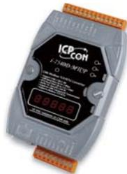
繼承 I-7540D 的所有功能，I-7540D-MTCP 使 CAN 總線能夠和網際網路或乙太網路結合。它不僅能夠透過乙太網訪問 CAN 總線，還能實現乙太網在 CAN 上的透明通訊。為了更便捷地將 PLC、HMI、SCADA 與 CAN 設備連結，I-7540D-MTCP 支援 Modbus TCP 及 Modbus RTU 通訊協定，可以作為 Modbus TCP 伺服器等待來自 Modbus TCP 客戶端的命令。當控制器是 Modbus RTU 主站設備時，I-7540D-MTCP 可以作為 Modbus RTU 從站，傳送 Modbus RTU 命令到 CAN 訊息。這些功能可以讓使用者更加靈活、方便地設置應用程式。
