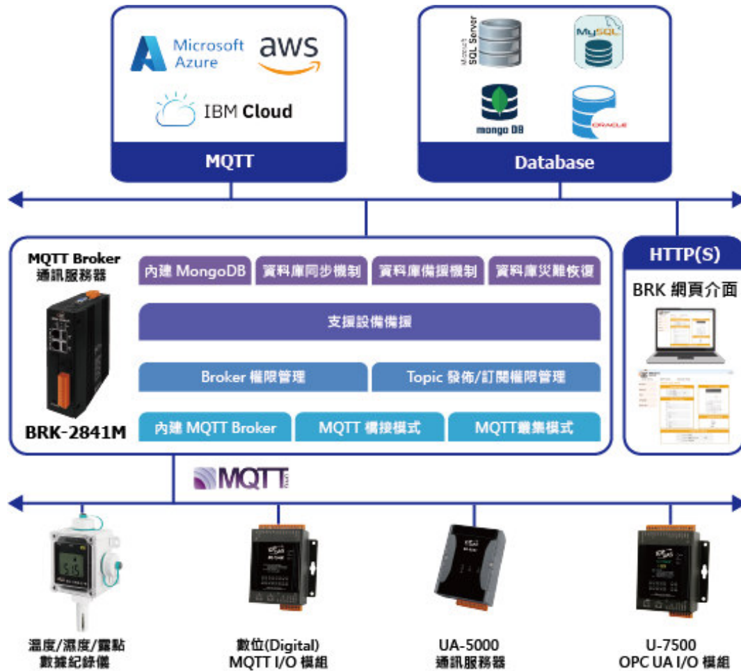
圖 3-1 BRK 的 MQTT 連線架構
