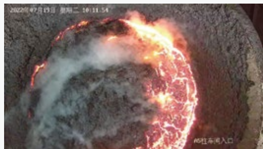
🔥 含水鋼渣倒入渣罐後產生氣爆
