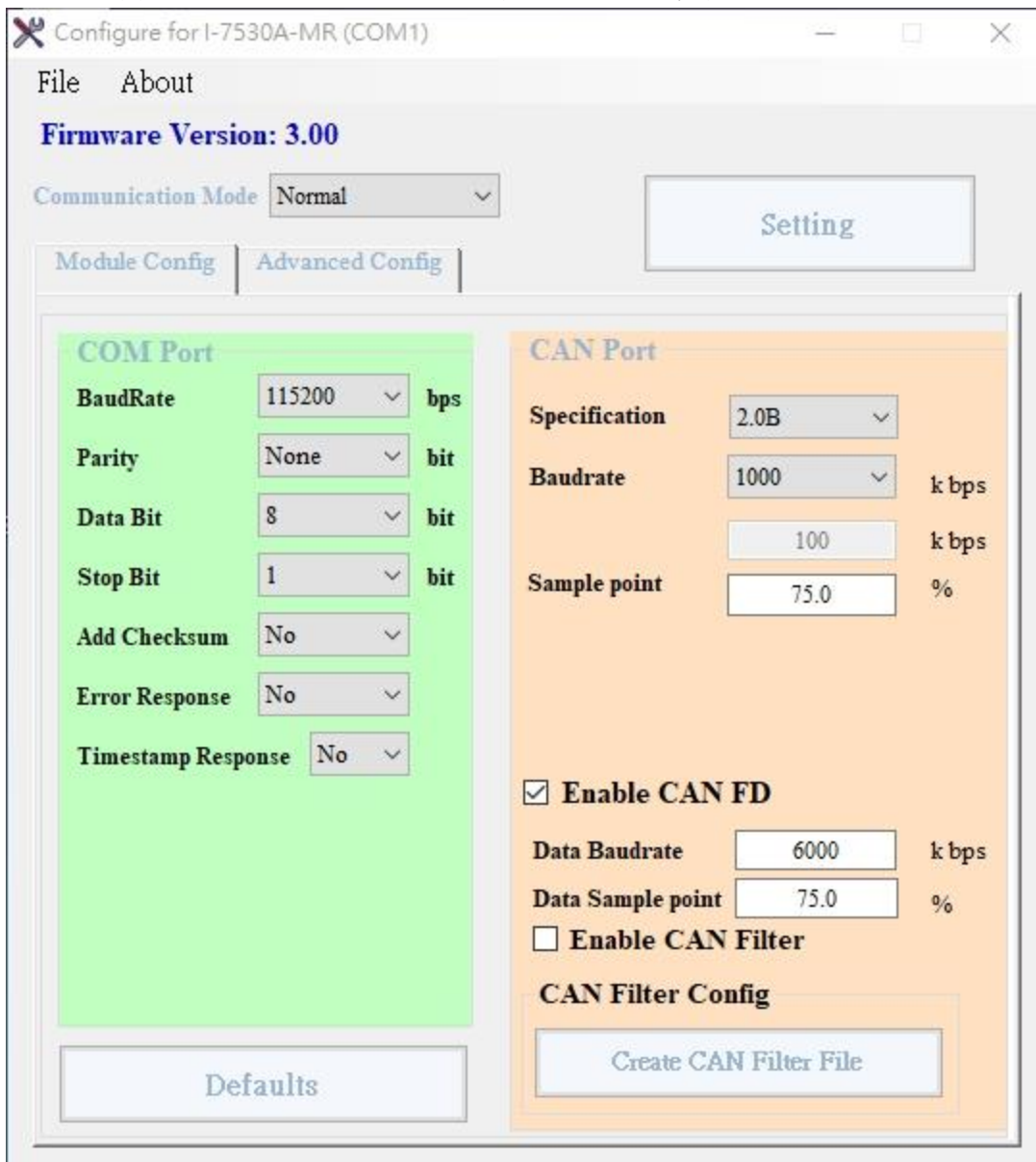
圖 3-8: I-7530A-MR-FD 模組設定格式(COM Port & CAN Port)
