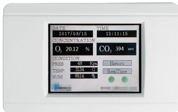
TPD-283U 使用 Modbus TCP 通訊方式與 uPAC-5001 進行資料交換，將 uPAC-5001 所收集到的量測值顯示於螢幕中。
