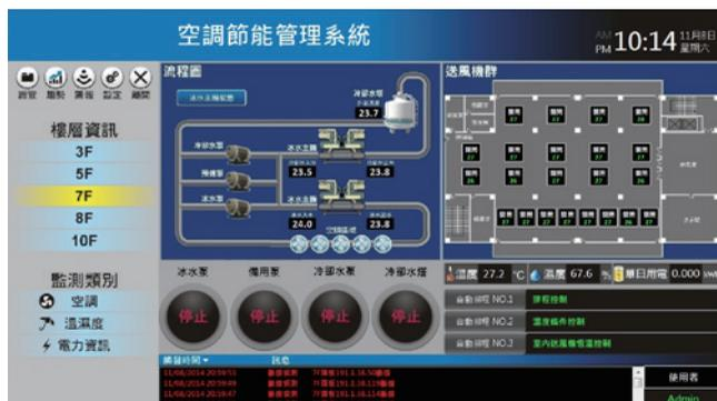
測冰水主機的入水跟回水溫度，適時調整溫度值；統一管控末端送風溫度，以減少冰水主機運轉能耗；記錄冰水主機運行週期，調整製冰時間，避開尖峰用電時段等，這些方式都能夠達到不同程度的能源管理。
