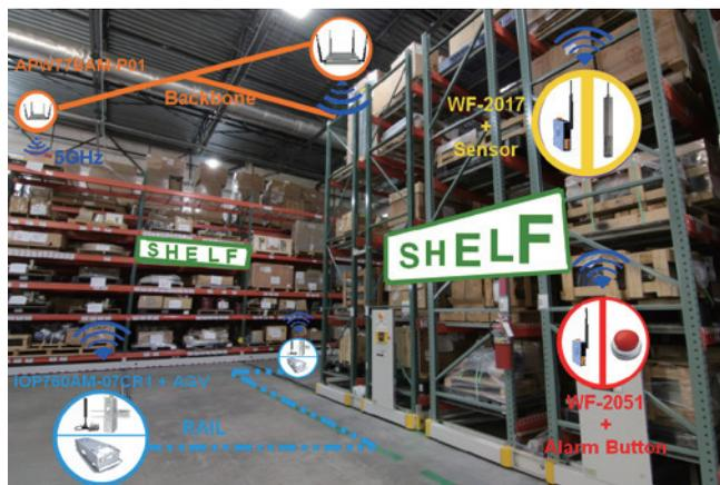
能使用 APW77BAM-P01 與 IOP760AM-07CR1 來實現無人搬運車倉儲系統，最主要是 APW77BAM-P01 內建快速漫遊 (Fast Roaming) 的功能，讓使無人搬運車 (AGV) 在兩個基地台移動時不會中斷通訊，即使無人搬運車要做長距離的移動，只要 APW77BAM-P01 擴展延伸到的 Wi-Fi 環境，就可以隨心所欲的通訊而不中斷。
